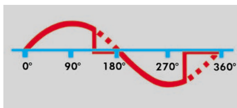
Phasenabschnittsteuerung für Glüh- und Hochvolt-Halogenlampen oder NV-Halogenlampen mit elektronischem Trafo sowie LEDs
